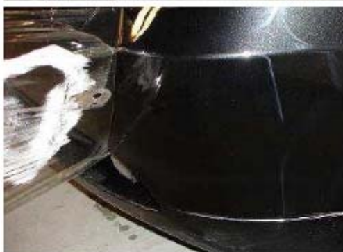
Рис. После удаления пленки на лакокрасочном покрытии не остается сколов и следов повреждения.
